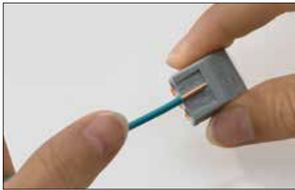
Striplengte Geleider 9 mm afstrippen
